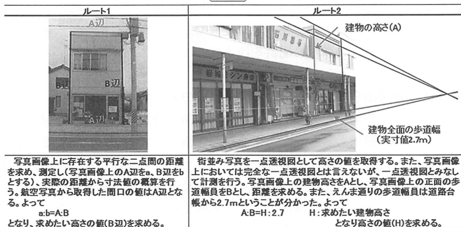
図1 写真測量の手法による建物高さの算出フロー
