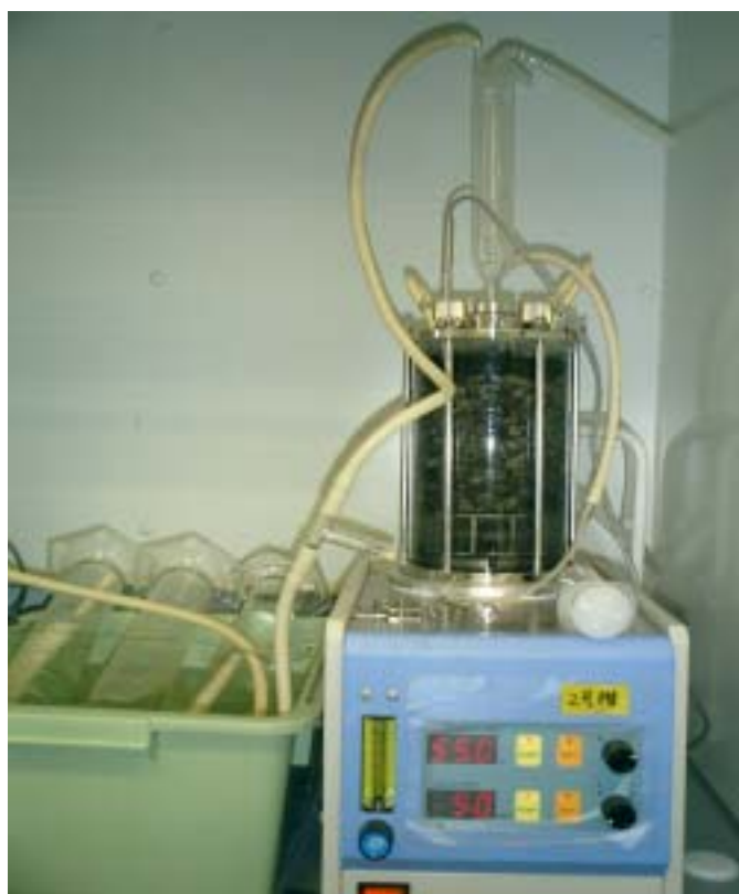
図1. ガラス製攪拌型培養槽
