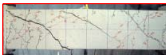
試験体 No.A-2 (破壊モード: F SP)
