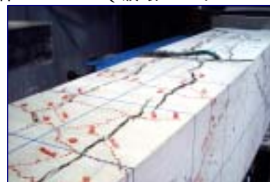
試験体 No.A-3 (上面割裂ひび割れ)
