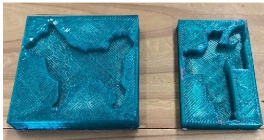
Fig. 9 学生が制作したクッキーの抜き型の初期試作品の 3D 出力
